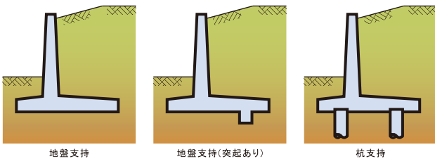
図2 擁壁の支持形式(逆T型の例)
