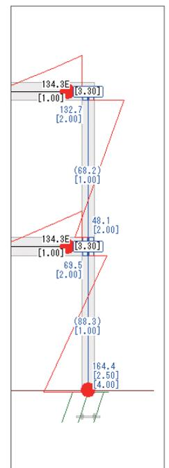
破壊モード図(抜粋)
