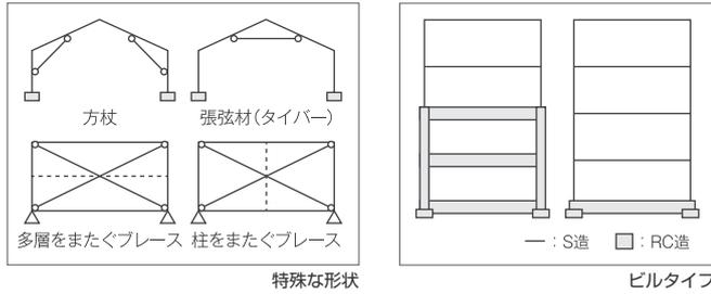
互いに直交するX、Y方向フレームで構成される建物のほか、平面傾斜フレーム、中折れフレームなどのある建物も扱います。
