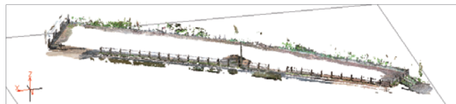
スキャンした駐車場の点群データ
