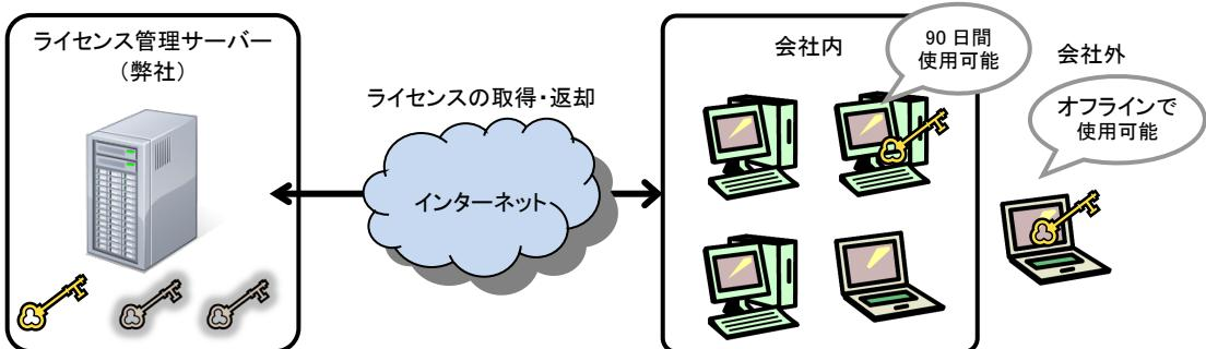
ライセンスは、プログラムの起動/終了時に自動的に取得/返却する方法と、最長 90 日間までパソコンに保持する方法があります。保持している場合はオフライン状態でも SNAP-WAVE を使用できます。
