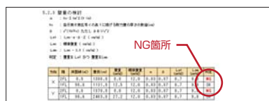
図8 壁量の検出力例
