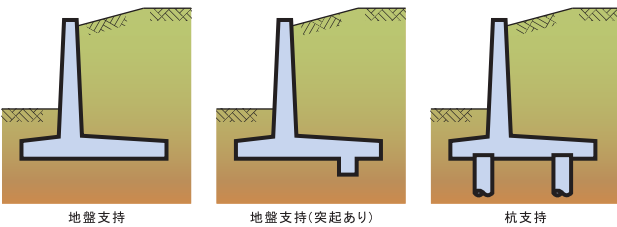
図2 擁壁の支持形式(逆T型の例)
